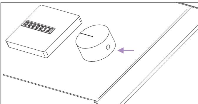
5 Der Luftstrom des Geräts kann mit dem Potentiometer am vorderen Bedienfeld gesteuert werden.
