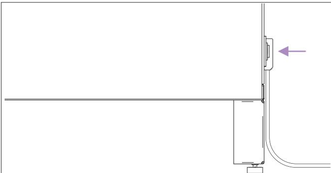
3 Schließen Sie das Gerät an das Stromnetz an und schalten Sie den Netzschalter an der Unterseite des Geräts neben der Steckdose ein.
