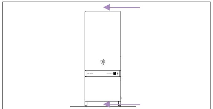
2 Stellen Sie sicher, dass die Luft unten und oben am Gerät ungehindert strömen kann und dass sich oben am Gerät keine Gegenstände befinden, die den Luftstrom behindern könnten.
