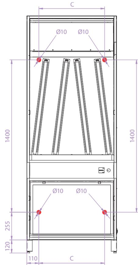
Markieren Sie die Position der Bohrlöcher durch die Löcher auf der Geräterückseite
